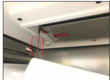
Figure 19b: Fan wires
